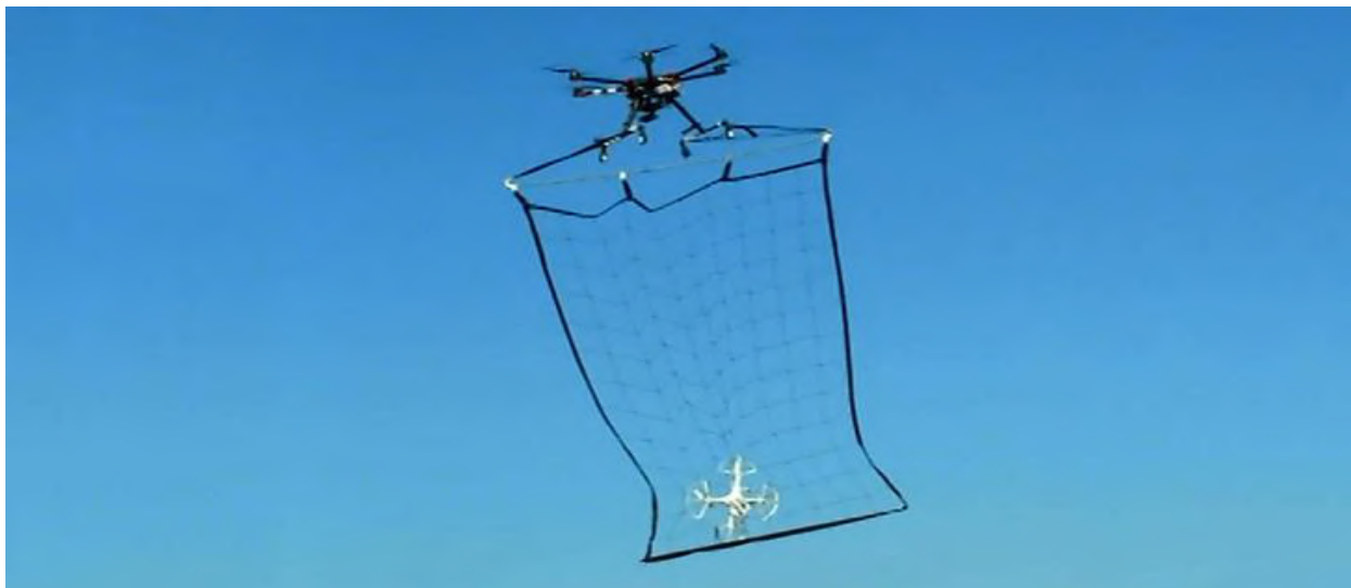
2-rasm. Maxsus to‘rlar bilan jihozlangan yuqori quvvatli dronlar noqonuniy uchuvchi boshqa dronlarni ushlamoqda.
