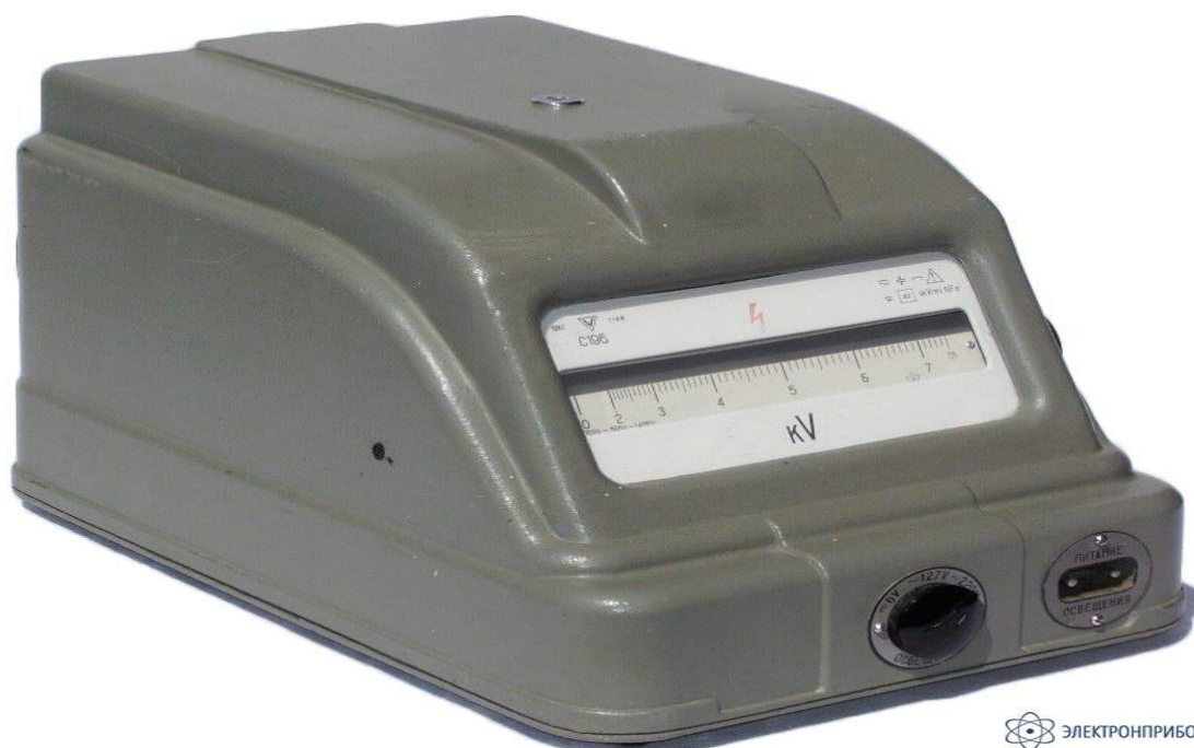
Rasm- 3. S196 - elektrostatik kilovoltmetr
