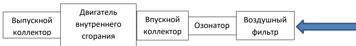
Рис 1. Схема подачи озоновой смеси в систему подачи воздуха ДВС.
