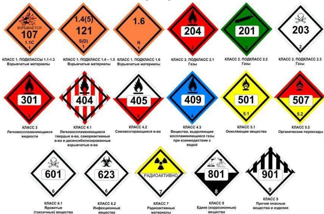
2-rasm. Xavfli yuklarning xususiyatini bildirib turuvchi maxsus belgilar
