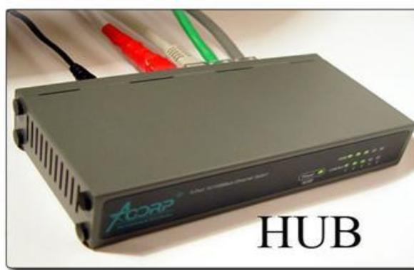
HUB (Switch) qurilmasidan foydalangan holda kompyuterni tarmoqqa ulash. Hub lar xonadagi kompyuterlarni bir-biri bilan bog'lash uchun kerak bo'lsa, Switchlar binolar orasiga qo'yiladi.
